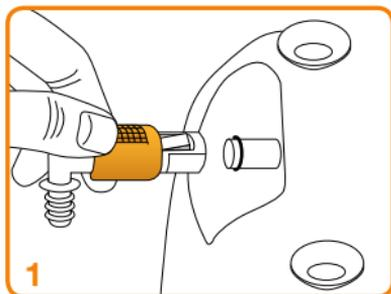
Beiliegenden Anschluss-schlauch am Gerät befestigen.
