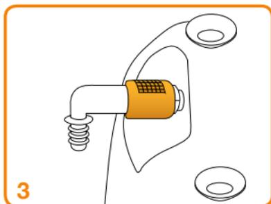
Ein „clix“ signalisiert Ihnen den sicheren Anschluss.
