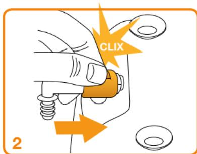
Sicherungsschieber auf **OFF** stellen, Anschluss auf Zu-laufstutzen des SPÜLBOY® stecken und anschließend den Schieber in die Stellung **ON** bewegen, um somit die Verriegelung zu aktivieren.
